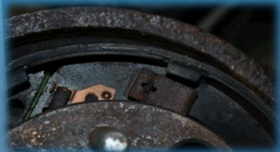
*L'état de ce véhicule, une Honda Civic 2001, a contribué à un accident mortel en 2016. L'inspection post accident a démontré que la défaillance des pistons et la fuite d'huile à frein sur les garnitures sont des facteurs. Est-ce qu'une inspection aurait pu prévenir ou minimiser cet accident mortel? Personne ne le saura, mais peut-être...)*
