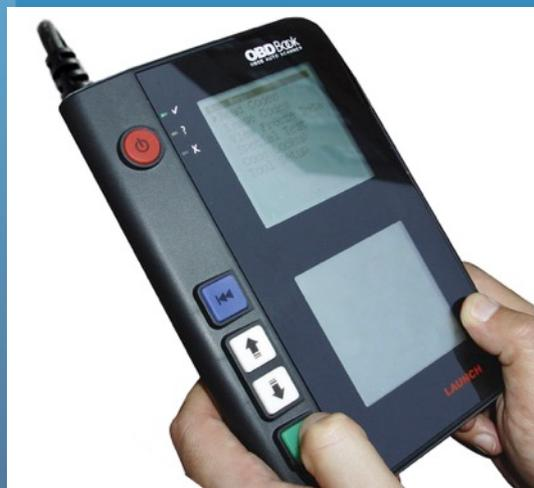
*OBD2 - Analyse, contrôle et active les systèmes d'évaluation*
