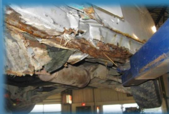
*L'état de ce véhicule, une Ford Focus 2002, a contribué à un accident mortel en 2015. L'inspection post accident a démontré un frein corrodé, une structure très affaiblie par la corrosion et les pneus usés à la corde. Est-ce qu'une inspection aurait pu prévenir ou minimiser cet accident mortel? Personne ne le saura, mais peut-être...)*
